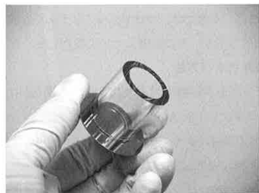
写真2 シリコンと接合した円筒ガラス
