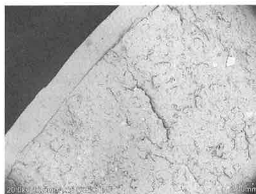
Fig. 5 抗折試験による破断面の SEM 像
