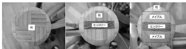
図3 竹合板および複合バットの断面 (左：竹合板、中：竹複合①、右：竹複合②)
