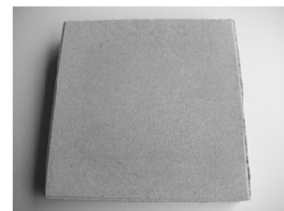
図1 非透水インターロッキングブロックA (300×300×60mm)
