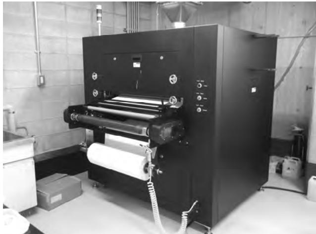
図 1. エレクトロスピニング装置の外観
