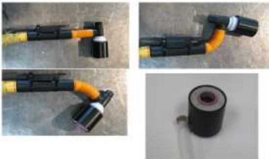
図1 試作2重シールド溶接トーチの外観
