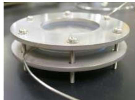
図3 試作した伝熱板
