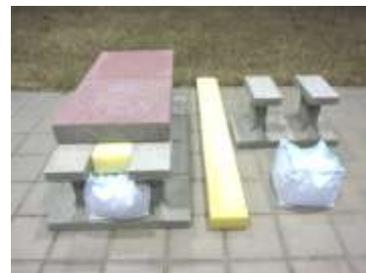
図1 コンクリート製品を床ユニットに転用した試作品(左:試験時、中央:スポンジ、右:保水材とブロック)
