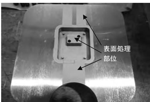
図1 放電傾斜皮膜生成法による金型部品の製作
