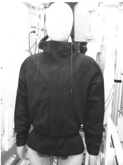
図1. 試作ウェア（衣服内湿度測定試験中）
