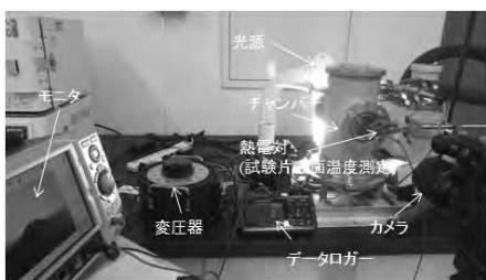
図1 静滴法による樹脂接触角測定装置の外観写真
