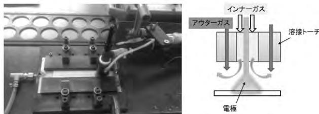
図1 ティグ溶接実験の概況と溶接トーチの構造
