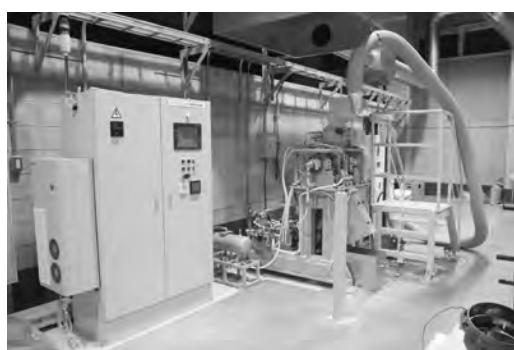
図1 セルロース混合可塑化成形装置
