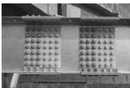
図1 ボルト締結一溶射処理1ヶ月の試験体
