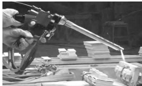
図2 現地狭隘部溶射施工用溶射ガンの外観
