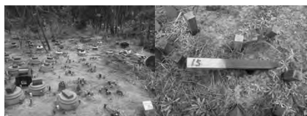
図 1 試験地とシロアリ被害のない注入木材試験杭
