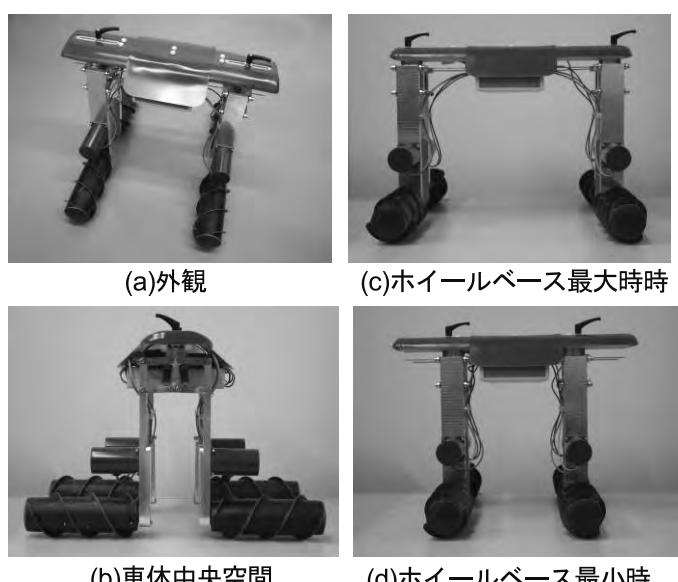
図2 試作機の構造
