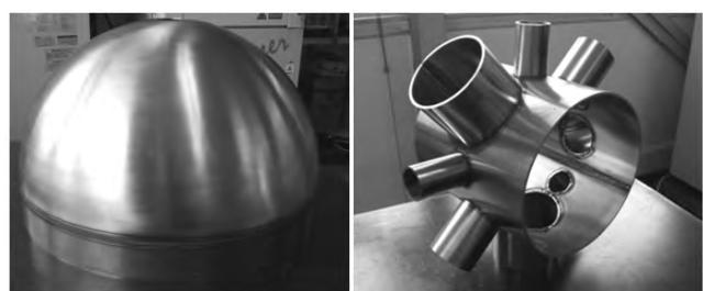
図5 試作ドーム型容器及び溶接構造枝管容器
