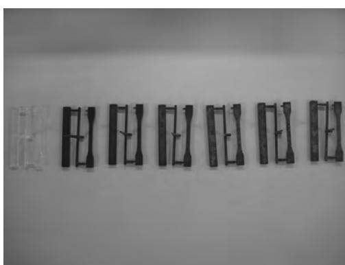
図 1 射出成形した試験片
