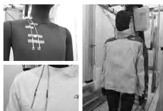
図2 センサの取付けとウエアの着装状態
