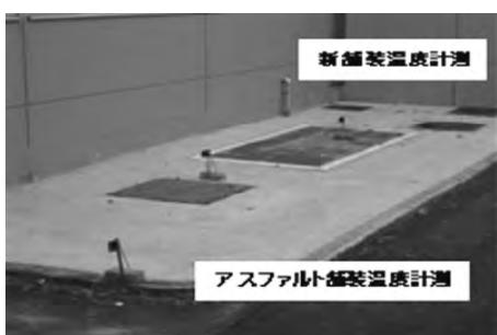
図1 コンクリート製品を床ユニットに使用した試作品
