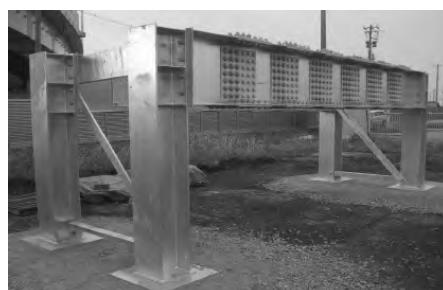
図4 暴露試験中の溶射施工した橋梁モデル
