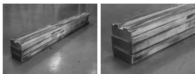
Fig. 3 曲げ加工適用後の樹脂積層中子
