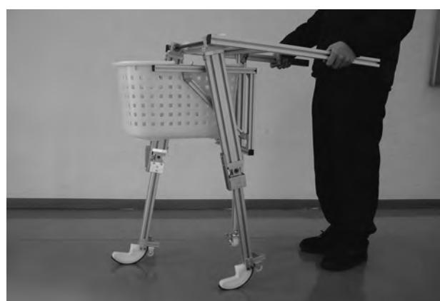
図3 運搬用受動的歩行ロボット
