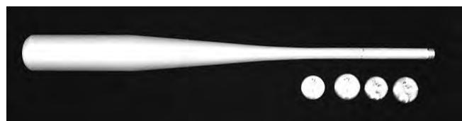
図2 試作したバットの外観（ボディとノブ）
