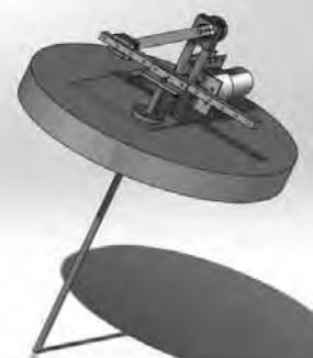
図1 3次元CADによる水面浮遊型ガス抜き・抑草ユニット試作機の設計
