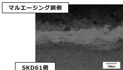
Fig. 3 接合界面の金属組織写真
