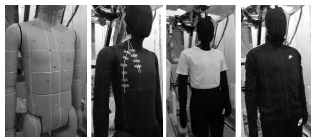
図1 温湿度センサの取付けと着装状態
