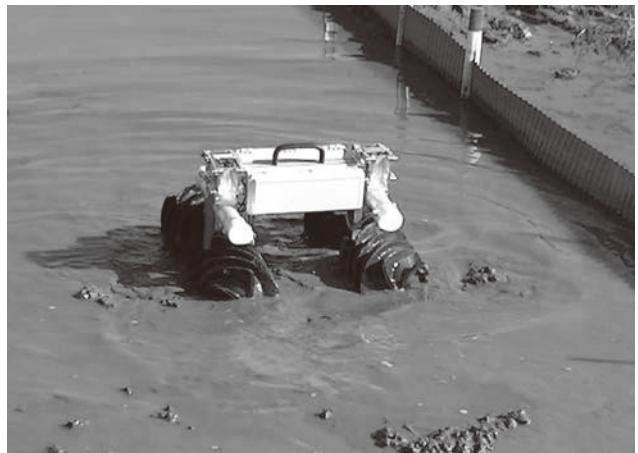
図 2 改良車輪駆動試験
