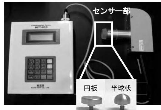
図1 携帯型圧縮試験機
