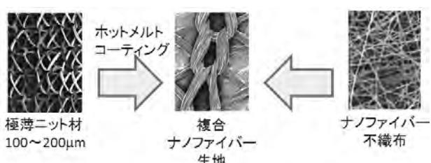
Fig. 2 ハイブリッド極薄基布の製法ならびにSEM観察図
