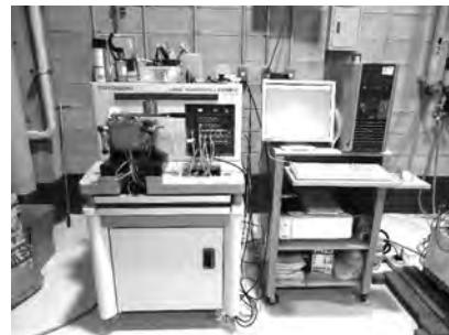
Fig. 1 Labo plastomill
