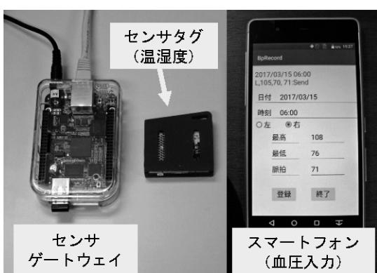
図2 住宅内設置機器 (Bluetooth 通信機器)
